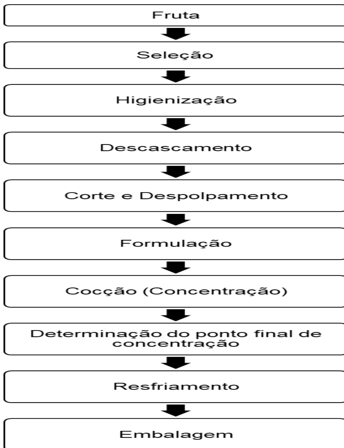
Figura 2. Sequência das etapas do processamento dos doces cremoso e em massa.
